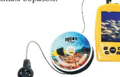
3.)Когда электропитание включено, нажмите кнопку Start, и монитор запуститься. Если Вы хотите выключиться,- только нажмите выключатель . После того, как электропитание выключено, монитор покажет картину в реальном времени изображения. Если камера не подключена к монитору , то монитор покажет картину НИКАКОГО СИГНАЛА,это напомнит Вам не забывать подсоединять камеру хорошо.
